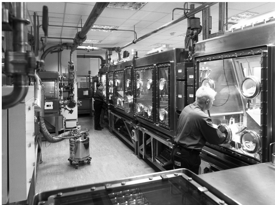
図 10 前セラフィールド MOX 燃料製造プラントのグローブ・ボックス・ライン
