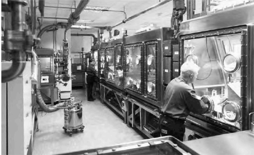
图 10.位于前塞拉菲尔德 MOX 燃料制造厂的手套箱流水线
