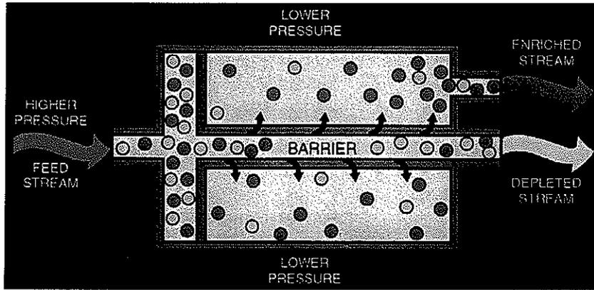
Fig. 7. Gaseous diffusion diffuser.
