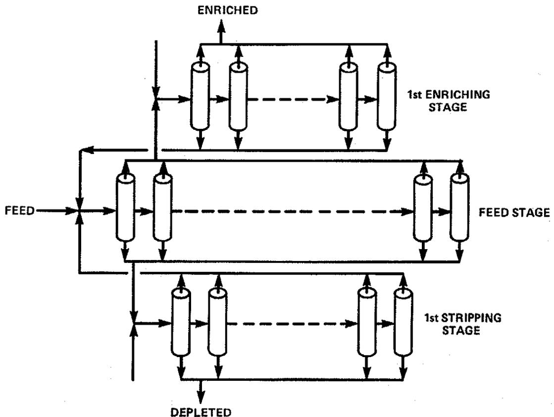
Fig. 18. Centrifuge cascade.
