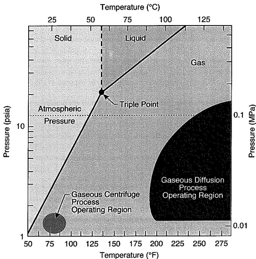
Fig. 25. UF<sub>6</sub> phase diagram.
