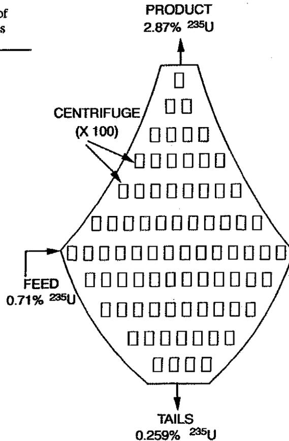
Fig. 20. Basic cascade arrangement.
